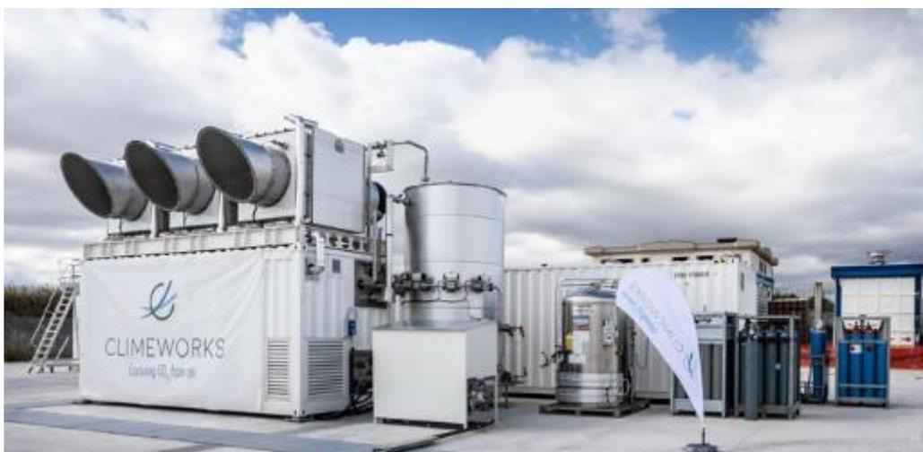
圖 6：Climeworks 的直接由空氣捕捉 CO<sub>2</sub>（DAC）設備
